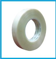
Als Schutzbandage bei Öltransformatoren hervorragend geeignet für hochbelastbare Anwendungen. Sehr reißfeste Glasfäden in Verbindung mit einer PET-Folie und einem wärmehärtendem Acrylatkleber. Die 114 µm Polyesterfolie bietet Durchstoß-, Kantenreiß-, und Abriebfestigkeit. Nach der Wärmebehandlung ist der Acrylatkleber beständig gegen Chemikalien, Lösungsmittel und Alterung. Das Band hat eine hohe Durchschlagsfestigkeit sowie gute elektrolytische Korrosionswirkung.
