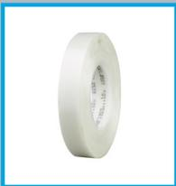
Perfekt zum Ablieben von Anschlussleitungen und Zwischenverbindungen, Bündeln von Wicklungen bei Motoren und Transformatoren. Ein hoch reißfester PET-Träger und ein wärmehärtender Acrylatkleber. Die 165 µm Polyesterfolie bietet Durchstoß-, Kantenreiß-, und Abriebfestigkeit. Dieses Band ist äußerst beständig gegen Chemikalien, Lösungsmittel und Alterung. Das Band hat eine hohe Durchschlagsfestigkeit sowie gute elektrolytische Korrosionswirkung.
