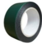
volzMount V5331 ist ein doppelseitig geschlossenzelliger PE-Schaum mittlerer Dichte, der mit einem Hochleistungs-Acrylklebstoffsysteem beschichtet und durch eine silikonisierte PE- Folienabdeckung geschützt ist. Das Band eignet sich für die Anwendungen bei Verglasungen sowie der Montage von Karosserieseitenleisten, Emblemen, Spiegeln, Etiketten, Kunststoffauskleidungen usw.
