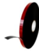
volzMount V5324 ist ein doppelseitiges Klebeband mit einem Transparenten  $67 \text{ kg} / \text{m}^3$  geschlossenzelligen PE Schaumträger und einem Weißen Lösungsmittel-Acrylkleber. Es hat einen sehr aggressiven Kleber und eine hohe Anfangsklebkraft.
