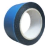
volzMount V5320 ist ein doppelseitiger, 0,8 mm starker, schwarzer, geschlossenzelliger PE-Schaumstoff mittlerer Dichte, der mit einem leistungsstarken Acrylklebstoffsysteem beschichtet und durch eine silikonisierte PP-Trennfolie geschützt ist. Er wurde für Verglasungsanwendungen, die Montage und den Einbau von Karosserieseitenleisten, Emblemen, Spiegeln, Etiketten usw. entwickelt. Mit Kunststofffolie für einfaches Entfernen.
