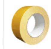
volzMount V5317 ist ein doppelseitig klebendes Band mit einem geschlossenzelligen PE Schaum als Träger sowie einem transparenten lösemittelfreiem Acrylatkleber. Das Band zeichnet sich u.a. durch eine hohe Klebkraft, einen hohen Tack und einer hohen Kohäsion aus.
