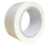
volzMount V5312 ist ein doppelseitiges, selbstklebendes Klebeband mit einem geschlossenzelligen PE-Schaumträger mittlerer Dichte und einem leistungsstarken Acrylatkleber. Es verfügt über eine hohe Anfangshaftung und Scherfestigkeit, eine ausgezeichnete UV- und Alterungsbeständigkeit und haftet gut auf einer Vielzahl von glatten und rauen Oberflächen. volzMount V5312 ist für allgemeine Montage- und Zusammenbauanwendungen in der Bau-, Automobil-, Mobil- und Konstruktionsindustrie geeignet.
