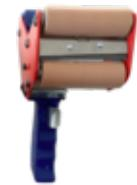
volzHandabroller 161-21403 ist ein professioneller Handabroller für Klebebänder zum Verschließen von Kartonagen und Packstücken. Mit Rollenbremse auch besonders gut für leicht abrollbare Verpackungsklebebänder geeignet. Durch zwei Anpressrollen lässt sich das Klebeband besonders einfach und glatt anbringen. Das Abschneiden des Klebebandes wird durch Betätigen des Auslösers im Handgriff ausgeführt und schützt so vor Verletzungen.
