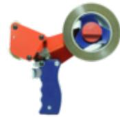
volzHandabroller 161-21402 ist ein professioneller Handabroller für Klebebänder zum Verschließen von Kartonagen und Packstücken. Mit Rollenbremse auch besonders gut für leicht abrollbare Verpackungsklebebänder geeignet. Durch zwei Anpressrollen lässt sich das Klebeband besonders einfach und glatt anbringen. Das Abschneiden des Klebebandes wird durch Betätigen des Auslösers im Handgriff ausgeführt und schützt so vor Verletzungen.
