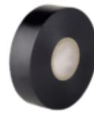
volzFlex 1086 PV5 ist ein 0,18 mm dickes, professionelles, selbstverlöschendes, elektrisch isolierendes Weich-PVC-Klebeband in Premiumqualität, das ein aggressives, druckempfindliches Klebstoffsyste auf Kautschuk Basis verwendet. Das Band entspricht REACH und der europäischen Richtlinie 2011/65/EG (RoHS 2) und der delegierten Richtlinie (EU) 2015/863 der Kommission (RoHS 3).
