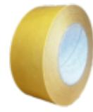
volzFix V4152 ist ein doppelseitiges Klebeband bestehend aus einem Vliesträger und einer Transparenten Hotmeltklebemasse auf Kautschukbasis. Das Produkt ist geeignet für permanente Verklebungen von Kartonagen, Katalogen und Papier bei denen keine hohen Temperaturbelastungen auftreten. Der hohe Masseauftrag ermöglicht Verklebungen auf rauen und strukturierten Oberflächen und zeigt eine hohe Anfangsklebkraft.
