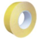
volzFix V4140 PV1 ist ein doppelseitiges Klebeband bestehend aus einem Transparenten BOPP-Folienträger und einer Transparenten Hotmeltklebemasse auf Naturkautschukbasis. Das Produkt ist geeignet als Teppichverlegeband oder zur Verklebung von Metallen, Kunststoffen, Fotos usw. bei denen keine hohen Temperaturbelastungen auftreten. Es zeigt eine hohe Anfangsklebkraft.
