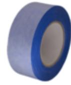
volzFix V4123 PV2 ist ein doppelseitiges Klebeband bestehend aus einer Blauen PE-Folie und einer Transparenten differenzierter stark / schwach Hotmeltklebemasse auf Naturkautschukbasis. Das Produkt ist sehr gut geeignet als Messeverlegeband.
