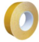
volzFix V4030 ist ein doppelseitiges Klebeband bestehend aus einem Baumwollgewebeträger und einer Weißen Hotmeltklebemasse auf Naturkautschukbasis, weichmacherfrei. Das Produkt ist geeignet als Teppichverlegeband. Der hohe Masseauftrag ermöglicht Verklebungen auf rauen und strukturierten Oberflächen und zeigt eine hohe Anfangsklebkraft.
