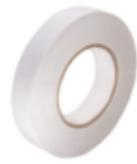
volzFix 9086 ist ein doppelseitig klebendes Vliesklebeband bestehend aus einem Vliesträger und einer modifizierten Lösemittelacrylatklebemasse. Es zeichnet sich durch eine sehr gute Klebkraft und sehr hohe Temperaturbeständigkeit aus und ist auch geeignet für schwierige Anwendungen. Das Band besitzt eine gute UV-Beständigkeit und verträgt sich gut mit anderen Materialien.
