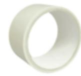
volzFix 9082 ist ein doppelseitiges Klebeband bestehend aus einem Polyesterträger und einer modifizierten Lösemittelacrylatklebemasse. Es zeichnet sich durch eine sehr gute Klebkraft aus. Das Band besitzt eine gute UV-Beständigkeit und verträgt sich gut mit anderen Materialien.
