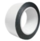
volzMount 9076P ist ein doppelseitig klebendes Klebeband aus Polyurethanschaum, der mit Acrylatkleber beschichtet ist. Der geschlossenzellige Schaum bietet durch das hohe Raumgewicht eine geringe Komprimierbarkeit und dennoch eine gute Ausgleichsfähigkeit bei unebenen und rauen Oberflächen.
