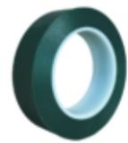
volzElektro 6215 PV6 wird aus einer 2 mils dünnen PET-Folie mit einem 1,2 mils hocheffizienten Silikonkleber hergestellt. Es ist ein hervorragendes Abdeckband für die Pulverbeschichtung. Das Band hat eine ausgezeichnete Beständigkeit gegen korrosive Chemikalien und ist extrem flexibel und anpassungsfähig. Rückstandsfrei ablösbar.
