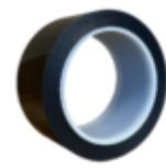
volzElektro 6215 PV4 wird aus 50µm Polyesterfolie hergestellt, die auf einer Seite mit einem hochwertigen Silikonklebstoff beschichtet ist. Entwickelt für Abdeckungen bei hohen Temperaturen, bei denen eine starke Unterlage in Kombination mit einem ausgezeichneten chemikalienbeständigen Klebstoff erforderlich ist.
