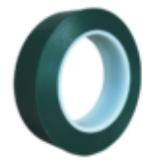
volzElektro 6215 PV3 ist eine 2 mil Polyesterfolie (PET) mit 1,20 mil hochwirksamem Silikonkleber. Dieses Produkt wurde entwickelt, um eine hohe Klebrigkeit und Haftung zu bieten, und hat eine starke Beständigkeit gegen korrosive Chemikalien. Es lässt sich leicht und ohne Klebstoffrückstände von der Oberfläche entfernen und eignet sich daher hervorragend zum Abdecken und für die Pulverbeschichtung.
