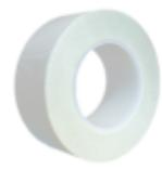
volzElektro 6017 PV5 besteht aus einem hochreißfesten Glasgewebeträger, der mit einem wärmehärtenden Acrykatkleber beschichtet ist. Das Klebeband hat eine ausgezeichnete Beständigkeit gegen Lösungsmittel. Zur Abdeckung bei Spulen-, Schicht- und Kabelbaumanwendungen.
