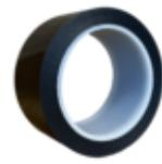
volzElektro 50501 (Aufbau: PET-Folie/Acrylatklebemasse) ist ein geschmeidiges und dehnbare Klebeband, das frei von korrosionsfördernden Bestandteilen ist. Außerdem ist das Produkt tränkmittelbeständig, licht- und alterungsbeständig, klebstark, UL-gelistet und schwer entflammbar. volzElektro 50501 ist UL 510 zertifiziert.
