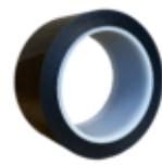
volzElektro 50501 (Aufbau: PET-Folie/Acrylatklebemasse) ist ein geschmeidiges und dehnbares Klebeband, das frei von korrosionsfördernden Bestandteilen ist. Außerdem ist das Produkt tränkmittelbeständig, licht- und alterungsbeständig, klebstark, UL-gelistet und schwer entflammbar. volzElektro 50501 ist UL 510 zertifiziert.
