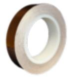
volzElektro 4384 PV1 besteht aus einer hochreißfesten Kupferfolie, beschichtet mit einer mit Silberpartikeln gefüllten Klebmasse von hervorragender Leitfähigkeit. Die Klebmasse wird durch ein Trennpapier geschützt. Das Band ist lötfähig und eignet sich für vielfältige Anwendungen im Bereich EMY/ESD.
