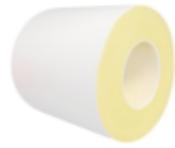
volzElektro 11350-1-DS ist ein doppelseitiges Polyester-Film-Isolierklebeband. Es wird aus einer 1mil PET-Folie und einem flammhemmenden, wärmehärtenden Acrylatkleber hergestellt. Es eignet sich für den Einsatz in einer Vielzahl von elektrischen Anwendungen. Dieses Band ist abrieb- und durchstoßfest, wärmehärtend, chemikalien- und Lösungsmittelbeständig und hat ausgezeichnete Isolereigenschaften.
