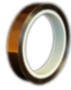
volzElektro 1018 ist eine 25 $\mu$  dicke Kapton® Polyimidfolie, einseitig beschichtet mit einem Silikonkleber. Das Band ist vielseitig einsetzbar in Schutz- und Elektro-Isolieranwendungen im Hochtemperaturbereich. (180°C Isolierstoffklasse H)
