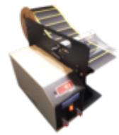
volzDispenser 161-0622-70/120/180 spendet einfach und schnell alle gängigen als auch spezielle Haftetiketten. Die Abtastung erfolgt foto-elektrisch. Die Spendegeschwindigkeit und der Etikettenvorschub sind stufenlos regelbar. Der eingebaute Zähler gibt an, wie viele Etiketten Sie bereits abgenommen haben.
