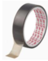
Saint-Gobain / h-old® TF50 ist eine PTFE (Polytetrafluorethylen)-Folie, die mit einem Hochtemperatur-Silikonklebersystem beschichtet ist. Entwickelt für Hochtemperatur-Isolierung, Trennfolie auf Walzen in vielen Industrien, Aushärtungsprozess von Verbundwerkstoffen und alle Anwendungen, bei denen eine geringe Friktion, Antihaltwirkung und nicht-toxische Eigenschaften erforderlich sind. Flammhemmend (UL 510)
