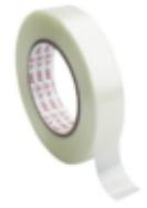
Saint-Gobain / h-old® PR25 ist eine glasfaserverstärkte PET-Folie, die auf einer Seite mit einem wärmehärtenden Kautschukklebstoffsysteem beschichtet ist. Entwickelt für Halteanwendungen, bei denen eine hohe Zugfestigkeit, gute Anfangsklebkraft und thermische Beständigkeit erforderlich sind.
