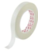
Saint-Gobain / h-old® GL94 ist ein glasgewebebeschichtetes Klebeband mit einem hochwertigen Acrylklebstoffsysteem. Entwickelt für Spulenumwicklungen, Zwischenlagen- und Kreuzungsisolierungen, Kabelbäume und alle Anwendungen, bei denen mechanische und Wärmebeständigkeit erforderlich sind.
