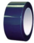
Intertape® 6120 ist ein Polyesterklebeband mit Silikonkleber. Konzipiert für Vorgänge wie z.B. das Abdecken von Oberflächen während des Auftragens von dauerhaften "Pulverbeschichtungen". Der Polyesterträger bietet Flexibilität und Anpassungsfähigkeit sowie Beständigkeit gegen Lösungsmittel und andere Chemikalien. Es kann rückstandsfrei von Oberflächen entfernt werden. Es eignet sich zum Anbringen von sauberen und exakten Lackierlinien. Das Band besticht durch eine hohe Reißfestigkeit.
