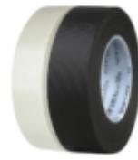
Intertape® 4627 ist ein reißfestes Glasgewebe-Klebeband mit einer wärmehärtenden Kautschukklebemasse. Es ist für Dauertemperaturen bis 155°C – Isolierstoffklasse F – ausgelegt und ist UL-gelistet. Intertape® 4627 ist für mechanische und Isolationsaufgaben in elektrischen Maschinen und Geräten einsetzbar.
