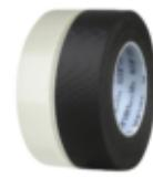
Intertape® 4616 ist ein elektrisches Klebeband aus Glasgewebe. Der Glasfasergewebeträger verleiht hohe Temperaturbeständigkeit und thermische Stabilität und bietet eine hervorragende Abriebfestigkeit für eine Vielzahl von Anwendungen. Dieses Band bietet hohe Haftung und Reißfestigkeit. Auch ein wärmehärtendes Naturkautschukklebstoffsyste verleiht dem Band eine ausgezeichnete Lösungsmittelbeständigkeit.
