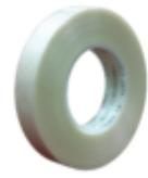
Intertape® 4237 besitzt einen reißfesten Träger (aus PET-Folie mit Glasfäden verstärkt) und mit einer wärmehärtenden Acrylatklebemasse beschichtet ist. Das Produkt ist tränkmittel-, licht- und alterungsbeständig. 4237 ist UL-gelistet. Es ist äußerst beständig gegen Chemikalien sowie transformatorenölbeständig bei: Shell Diala F, Ninas 10 Vetro GBN, Esso BP univolt 50. Die Beständigkeit gegen andere Öle ist individuell durch einen Test zu prüfen.
